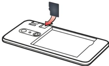
Die Halterung für die Speicherkarte befindet sich rechts oberhalb des Akkufachs. Schieben Sie die Data Card so in die Halterung ein, dass die goldenen Kontakt nach unten zeigen.
