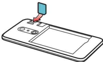
Die Halterung für die SIM-Karte befindet sich rechts oberhalb des Akkufachs und der Halterung für die Speicherkarte.
