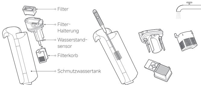
4. Installieren Sie den Filter und den Filterkorb wieder auf die Filter-Halterung und setzen Sie die Filter-Halterung in den Schmutzwassertank. Installieren Sie dann den Schmutzwassertank in den Sauger. Der Tank ist sicher befestigt, wenn Sie ein Klicken hören.
