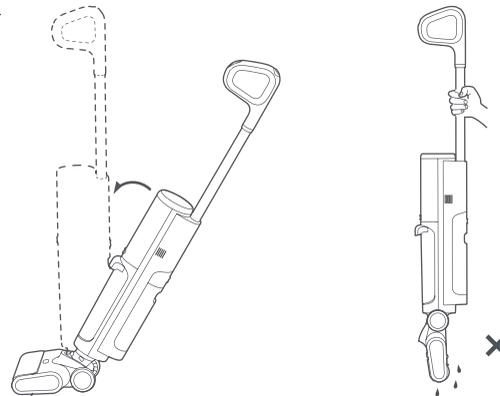
Wenn der Sauger pausiert oder ausgeschaltet ist, ziehen Sie den Griff nach hinten, um den Sauger mit Hilfe der Räder in die selbstreinigende Ladestation zu bringen. Stellen Sie den Sauger dann auf die Ladestation, um ihn aufzubewahren, aufzuladen und selbst zu reinigen.
