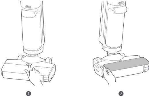
2. Drücken Sie die Entriegelungstaste der Walzenbürste und ziehen Sie die Walzenbürste wie abgebildet heraus.
