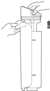
3. Nehmen Sie den Filter aus der Filter-Halterung und spülen Sie dann den Schmutzwassertank, den Filter, den Wasserstandsensor an der Filterhalterung und den Filterkorb aus, bis sie sauber sind.
