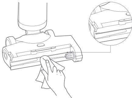
6. Installieren Sie die Walzenbürste und deren Abdeckung in dieser Reihenfolge wieder. Richten Sie beim Wiedereinsetzen der Walzenbürstenabdeckung diese an der Montageposition aus. Sie ist sicher befestigt, wenn Sie ein Klicken hören.
