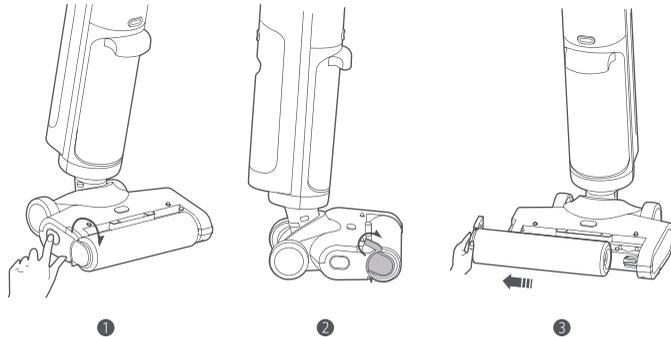
3. Drücken Sie die Taste und drehen Sie gleichzeitig den Schneider, um ihn herauszuziehen. Schneiden Sie dann mit dem Schneider die Haare ab, die sich auf der Walzenbürste und der Bodenbürste verfangen haben.
