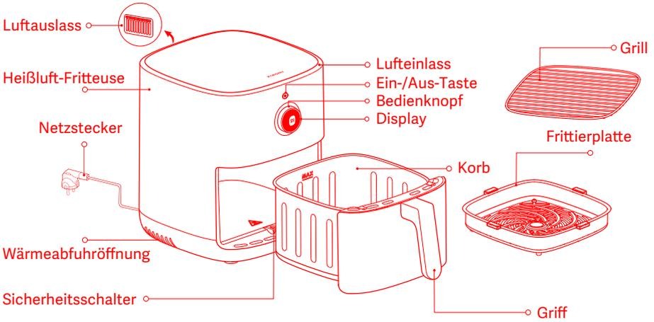
Hinweise: 1. Der Silikongummi auf der Frittierplatte besteht aus hochtemperaturbeständigen, lebensmittelechten Materialien, um zu verhindern, dass die Kanten der Frittierplatte die Beschichtung des Korbes zerkratzen und um die Stabilität der Frittierplatte zu verbessern. Entfernen Sie das Silikongummi nicht von der Frittierplatte.
